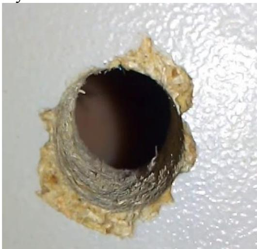
**Рисунок 1 – Дефекты обработки в виде сколов на входе сверла в материал**
