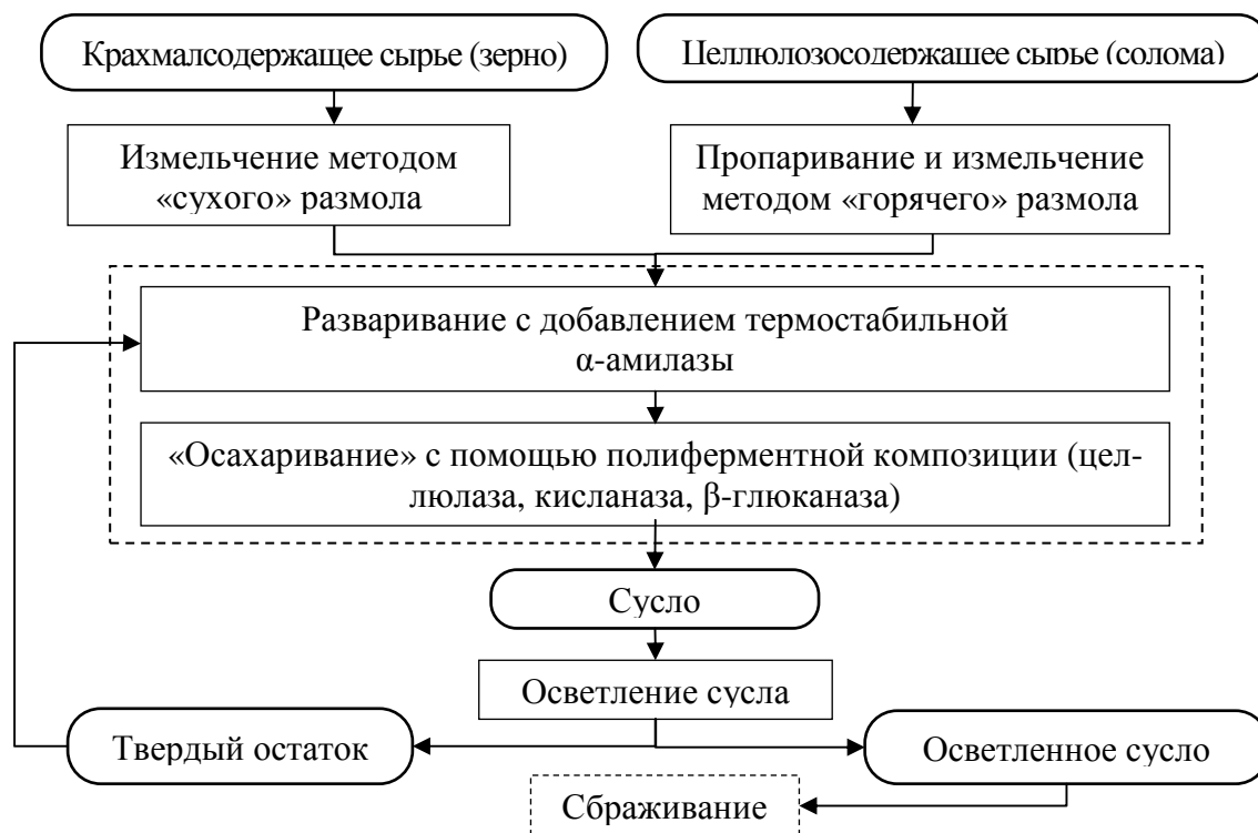
Рисунок. 2 – Принципиальная схема проведения «осахаривания» непрерывным способом
