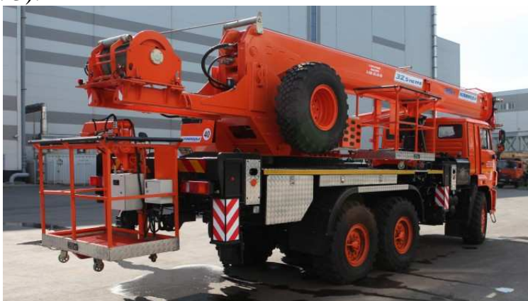
Рисунок 3 - Транспортное положение подъемника-крана ПКС-55713-4К-4В
