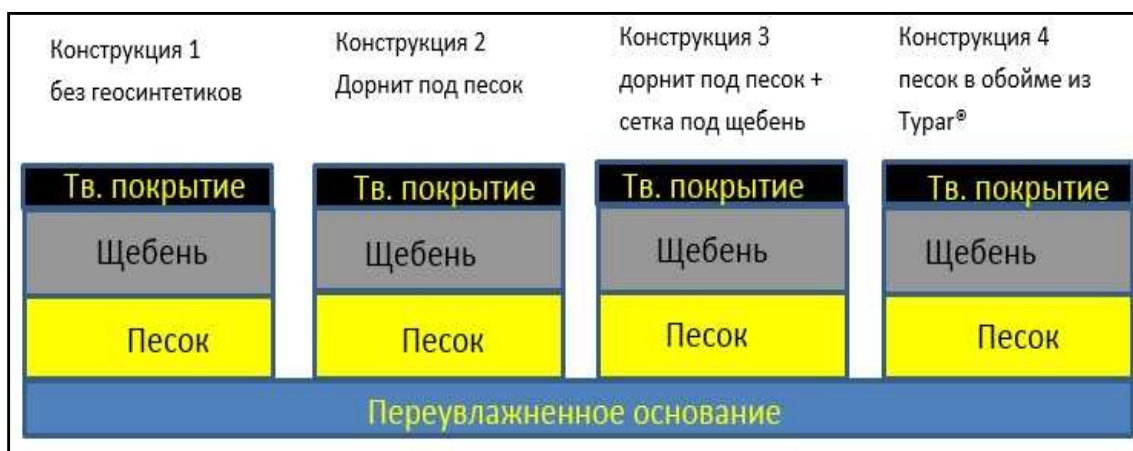
Рисунок 1 – Закладываемые опытные конструкции
