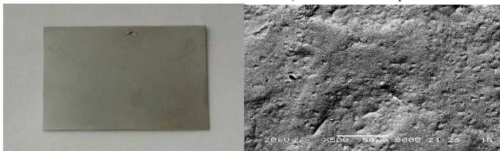
Рисунок 1 – Фотографии поверхности образца без увеличения (слева), с увеличением \times 500 (справа)
