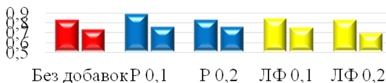
Рисунок 2 – Коэффициент старения резин по условной прочности при растяжении
