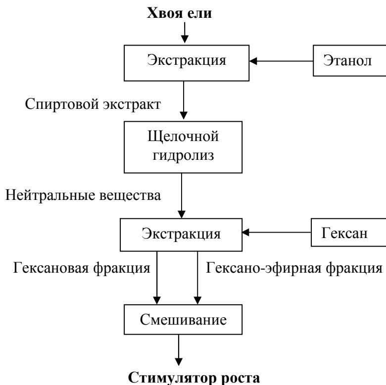
Рисунок 2 – Схема получения стимулятора роста из хвои ели на основе протекающих процессов щелочного гидролиза и экстракции [4]
