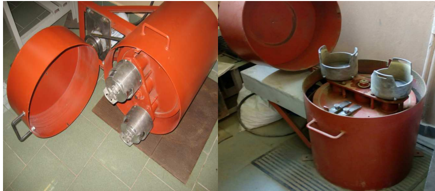
Рисунок 2 – Внешний вид промышленной планетарной мельницы периодического действия
