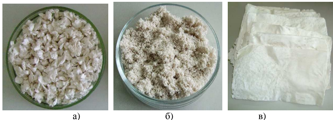
Рисунок 1 – Фотографии исходной целлюлозы (а), подготовленной к нитрованию: перетиранием через сито (б) и диспергированием в РПА, с последующим высушиванием в форме бумаги (в)
