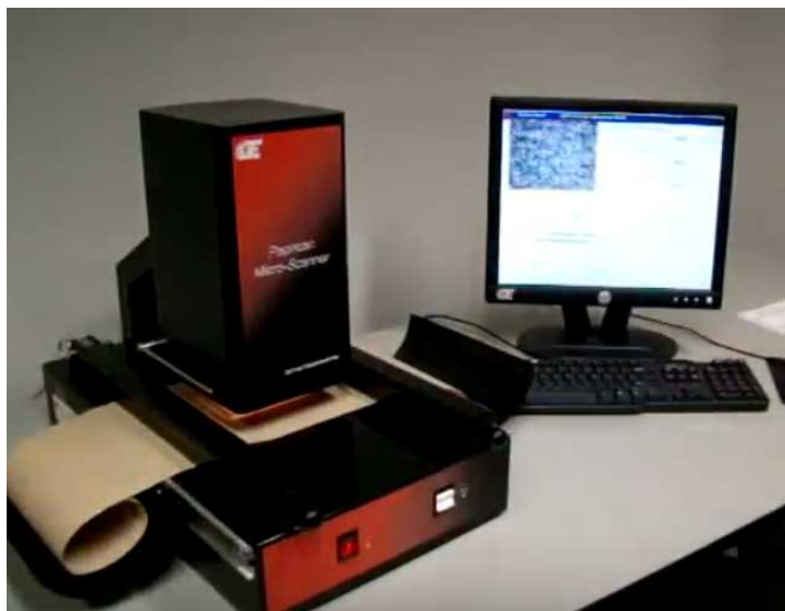
Рисунок 5 –Микросканер для определения сорности бумаги фирмы OpTestEquipmentInc
