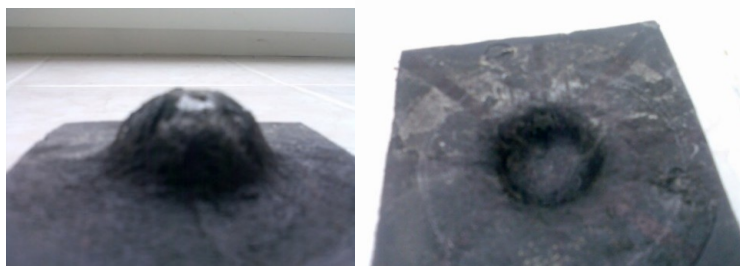
Рисунок 1 – Образцы после вдавливания сферическим пуансоном при температуре 150°C и давлении 0,9 МПа
