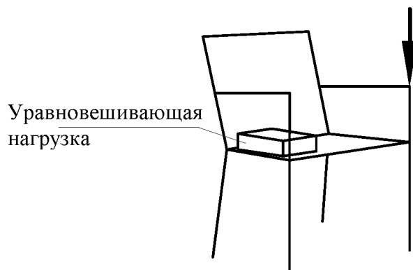
Рис. 12.5. Испытание подлокотников под воздействием статической нагрузки, направленной вниз
