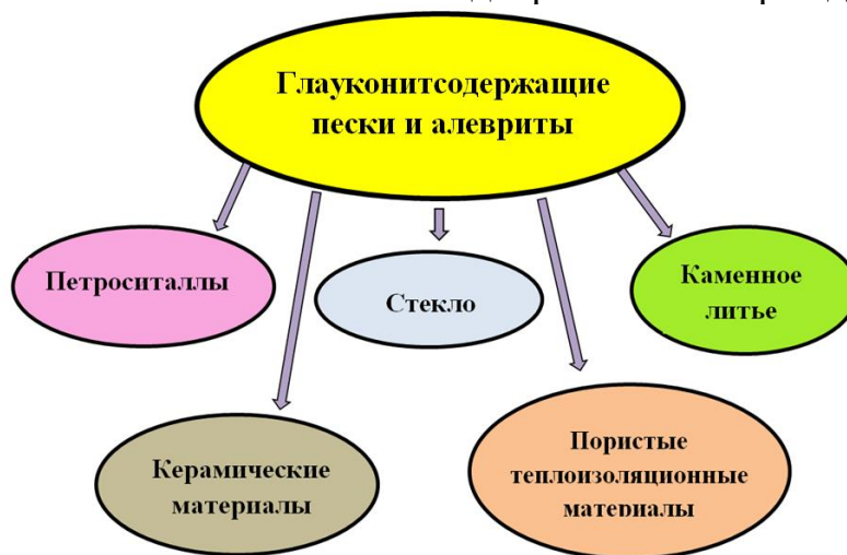
Рисунок 2 – Возможные направления использования глауконитсодержащих песков и алевритов Новодворского месторождения базальтов и туфов
