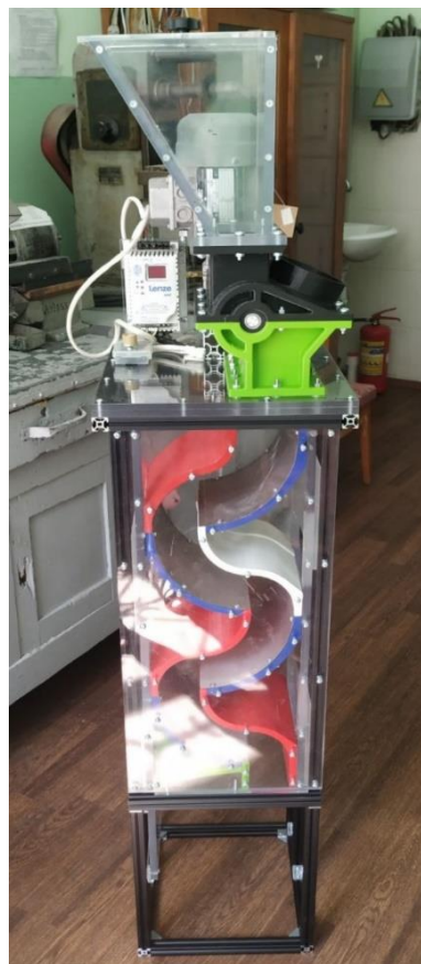
а) – принципиальная схема; б) – внешний вид экспериментальной установки; 1 – фильтровальный элемент, 2 – металлический корпус, 3 – патрубок с питателем для подачи влажного материала, 4 – ячейковый питатель 5 – вентилятор, 6 – шибер, 7 – патрубок для отвода фильтрата, 8 – патрубок отвода обезвоженного материала, 9 – емкость для сбора обезвоженного материала
